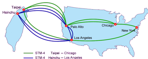
圖 6 TWAREN 國際線路 Lightpath 邏輯示意圖
